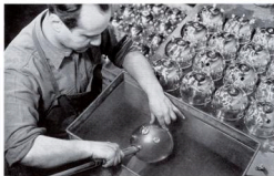
Är behållaren riktigt tät? Tryckluftspros avslöjar en felaktighet.
